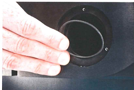
(D) • Remove the o-ring
