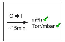
Die Pumpe erreicht die angegebenen Werte für Saugleistung und Endvakuum sowie die Dampfverträglichkeit (MZ 1C) erst bei Betriebstemperatur (nach ca. 15 min.).
