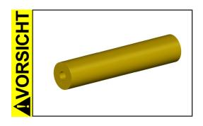
Übertragung mechanischer Kräfte durch starre Verbindungsleitungen vermeiden und elastische Schlauchstücke oder Federungskörper zwischenschalten.
