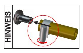
Schlauchverbindungen geeignet gegen unbeabsichtigtes Lösen sichern (z.B.: Schlauchschellen verwenden).
