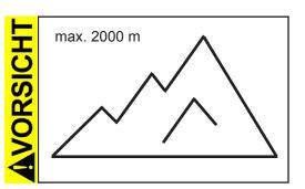
Bei einem Aufstellungsort über 2000 m über NN (Gefahr von unzureichender Kühlluftzufuhr) sind geeignete Maßnahmen und Vorkehrungen zu treffen.
