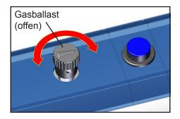
Bei kondensierbaren Dämpfen (Wasserdampf, Lösemittel, ....):
