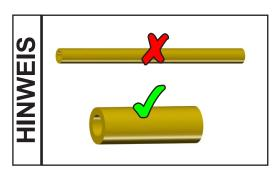
Kürzest mögliche Vakuumverbindungsleitungen großer Nennweite verwenden, um Drosselverluste zu vermeiden.
