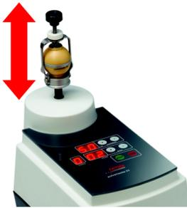
Die Mahlkugeln im Becher werden durch die hohe Beschleunigung des Mahlbechers in vertikaler Richtung in Schwingungen versetzt und zerkleinern das Mahlgut durch Prall und Druck der Kugeln gegen die Becherwände und der Kugeln untereinander. Durch den fast kugelförmigen Mahlraum bewegen sich die Kugeln nicht nur in vertikaler Richtung und es wird eine sehr effiziente Zerkleinerung erreicht.
